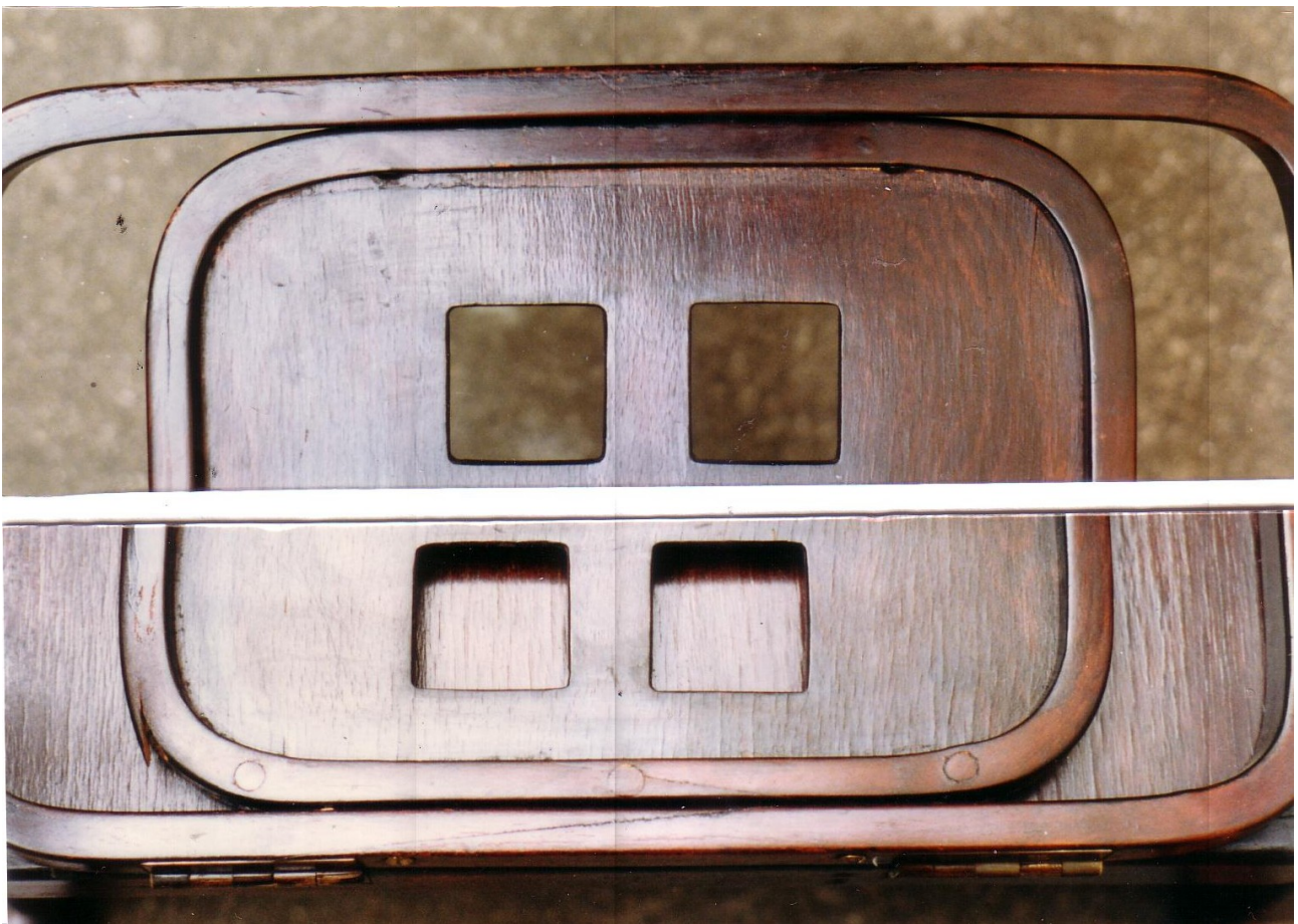
Abb. 9 Leimfugen an den Rückenrahmen
